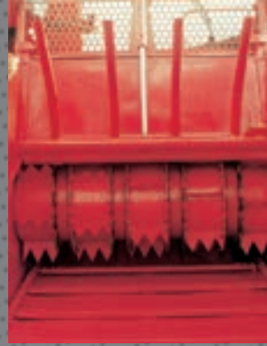
La paratoia rende la macchina più polivalente e permette di lavorare prodotti sciolti (segatura, mais, lolla di riso).
