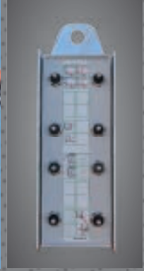
Comandi elettroidraulici con comando mobile in cabina trattrice.
