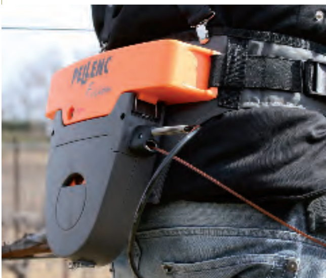
Le boîtier batterie et la bobine pour liens PELLENC
