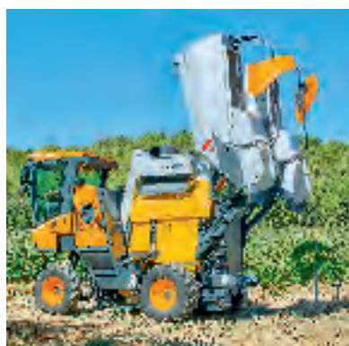
Vidage des bennes à 3 mètres
