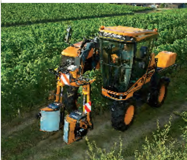
Effeuilleuse rang complet sur porteur OPTIMUM
