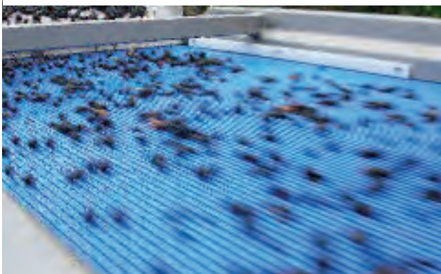
Tapis répartiteur et accélérateur des baies
