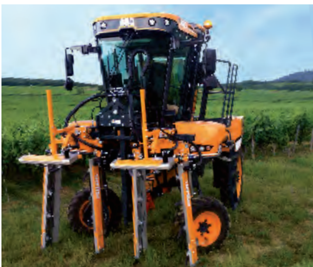
MULTIVITI enjambeur : 2 rangs avec écimeuses hydrauliques
