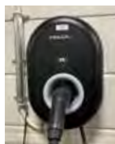
En option: borne de recharge Wallbox avec câble de rechargement Type 2, A464548
